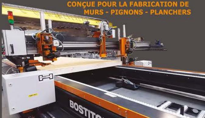
Montage et assemblage de l'ossature - couture des panneaux OSB
