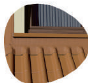
ÉTANCHÉITÉ DES MENUISERIES ET CHIENS-ASSIS
