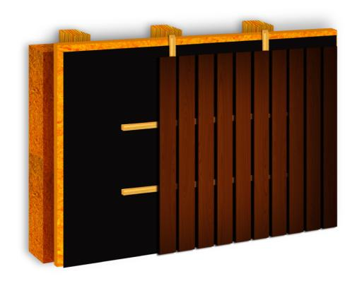
L'étanchéité au vent sera assurée par la pose d'une membrane pare-pluie HPV (hautement perméable à la vapeur d'eau) de type AEROPLUS UV3 ou similaire au moins conforme à la norme EN-13859-2, complexe bicouche avec comme support un film polyester noir, revêtu d'une enduction monolithique stabilisée aux UV.
