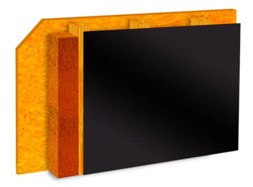
L'étanchéité à l'air sera assurée par une membrane pare vapeur classé au feu Euroclasse B avec une valeur Sd de 90m minimum de type AEROVAP B ou similaire conforme à la norme EN-13984, film PE noir ignifuge B S1 D0 co-extrudée 3 couches répondant aux caractéristiques techniques suivantes :
