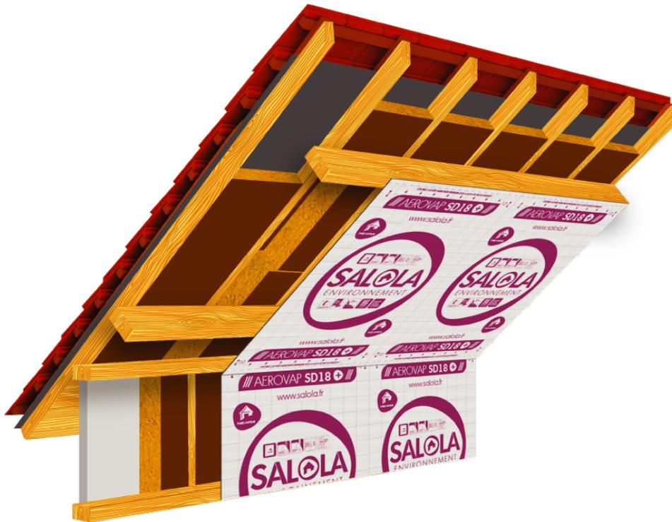
L'étanchéité à l'air sera assurée par une membrane avec une valeur Sd de 18m minimum de type AEROVAP SD18+ ou similaire conforme à la norme EN-13984 composée d'un Complexe de 2 couches de voiles non tissés ne PP enduction modifiée répondant aux caractéristiques techniques suivantes :
